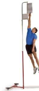
**Figura 1: Dispositivo Vertec responsável por medir a altura do atleta. Fonte: roguefitness.com**
