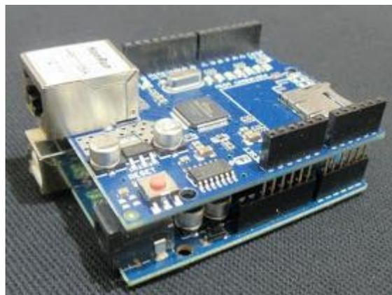
Figura 6.12. Encaixe do Módulo Ethernet [ARDUINO E CIA, 2013]
