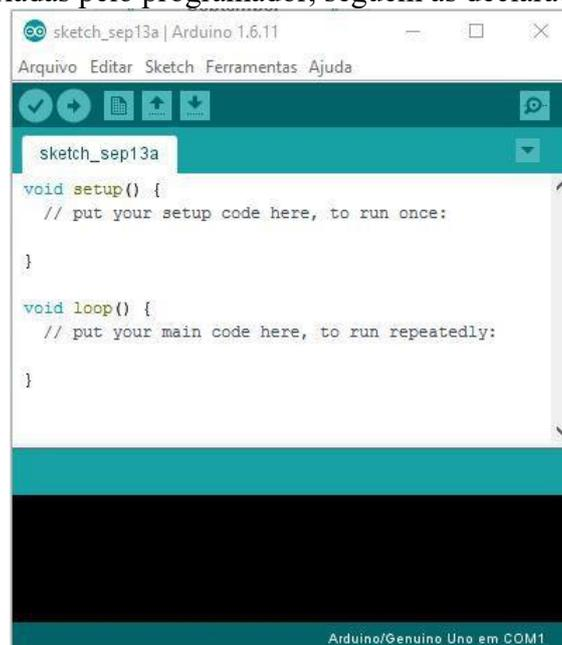
Figura 6.10. Código básico de programação do Arduino
